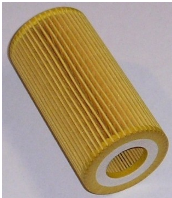
Zamjenski papirni filtar ulja kod automobila Volvo S40.
