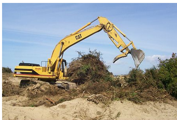
Hidraulički cilindri (5 komada) kod hidrauličnog bagera ili kopača osiguravaju velik zahvat materijala koji se kopa.
